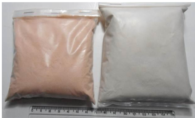
Fonte: Autoria própria FIGURA 5 – PRODUTOS OBTIDOS NA SEPARAÇÃO MAGNÉTICA
