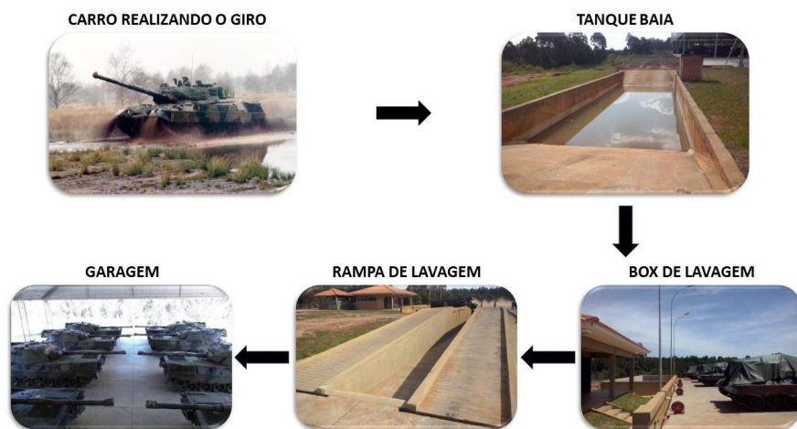
FIGURA 3. FLUXO DO DESLOCAMENTO DOS TANQUES
