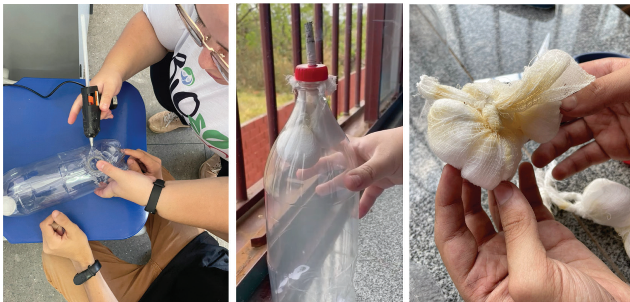
Figura 6 - Experimento do pulmão artificial simulando um indivíduo tabagista.
