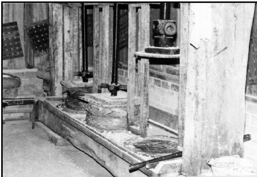
Figura 2 - Prensa mecânica tradicional utilizada no processamento de farinha de mandioca.
