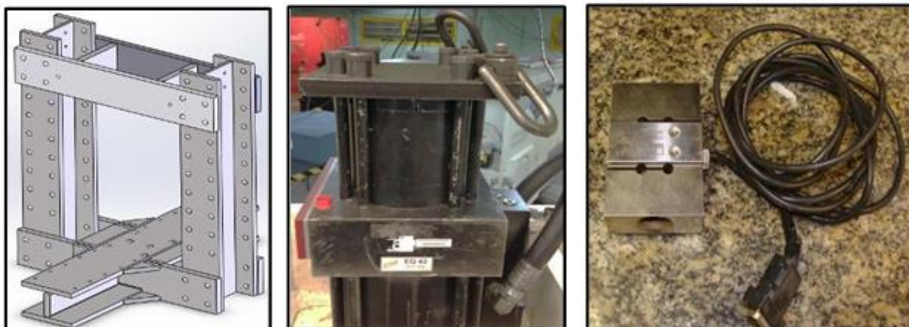
Figura 9 - a) Desenho do quadro da bancada utilizada no ensaio de flexão fadiga possui 2000 mm de altura por 1600 mm de comprimento, suportando amostras de até 2000 mm por 700 mm. A capacidade da carga em fadiga é de 500kN, b) Atuador Hidráulico da marca MTS, modelo 244.41 com capacidade de carga em fadiga de 500 kN. c) Célula de carga utilizada é da marca HBM modelo S40 com capacidade de 5 toneladas.
