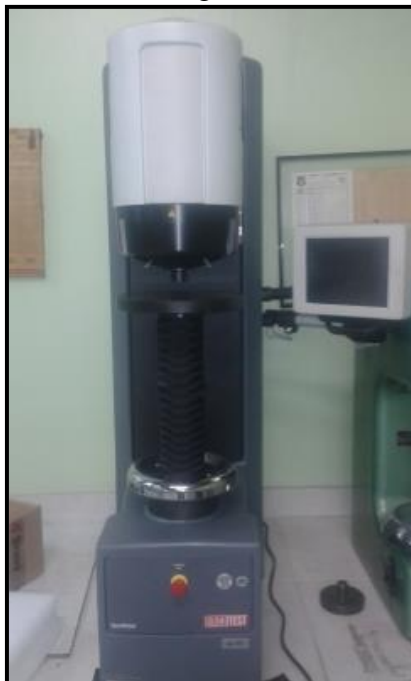
Figura 3 - Durômetro da marca DuraVision 30 para medições na escala Brinell. Fonte: Elaborada pela autora.
