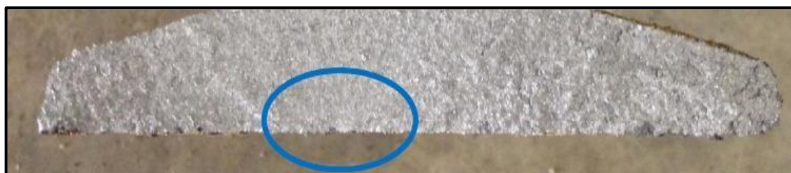
Figura 21 - Imagens da superfície de fratura do protocolo 04, após o ensaio de fadiga e estático, possível início da falha.
