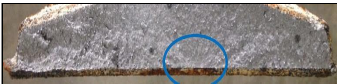
Figura 20 - Imagens da superfície de fratura do protocolo 02, após o ensaio de flexão estático, possível início da falha.
