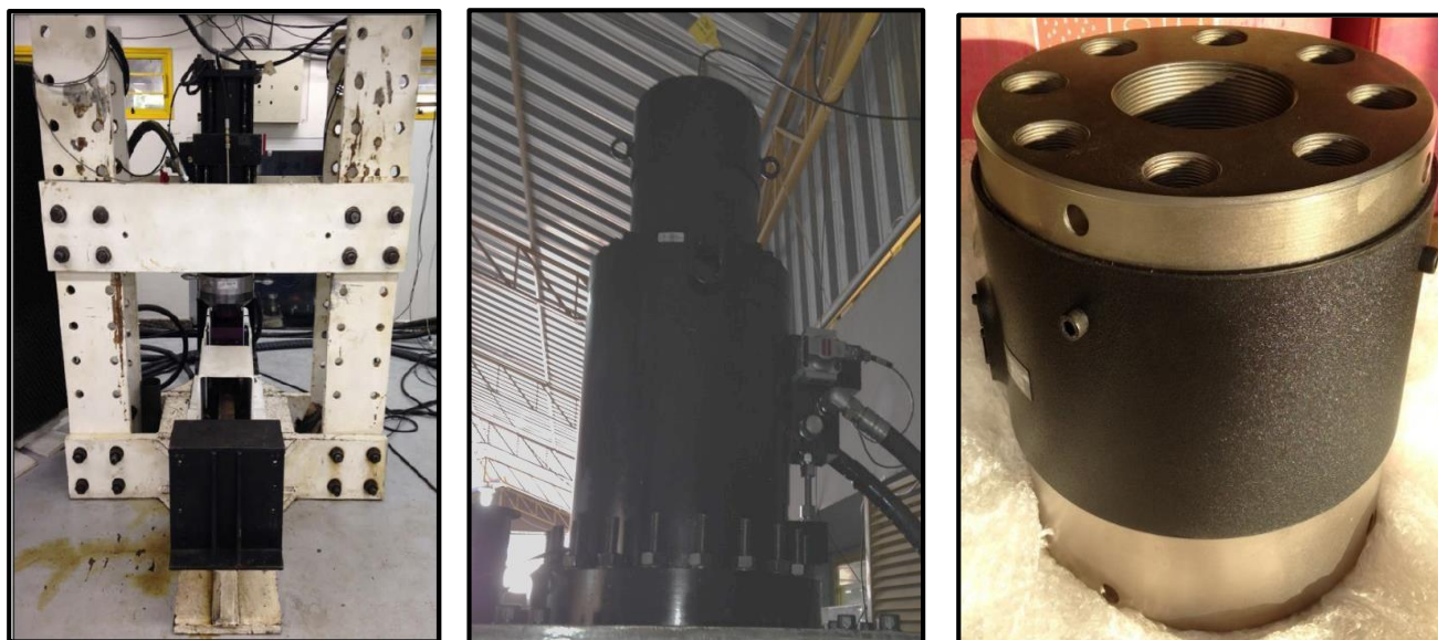
Figura13 - a) Bancada utilizada possui 1820 mm de altura por 2200 mm de largura. A capacidade de carga é de 1300kN. b) Atuador Hidráulico da marca Hidrausul, com capacidade de carga em fadiga de 1000 kN em tração e 1600 kN em compressão c) Célula de carga utilizada é da marca KRATUS com capacidade de 3000 kN. Fonte:
