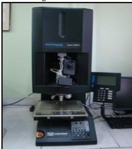
Figura 6 - Microdurômetro marca Instron na escala HV com carga de 300g. Fonte: Elaborada pela autora.
