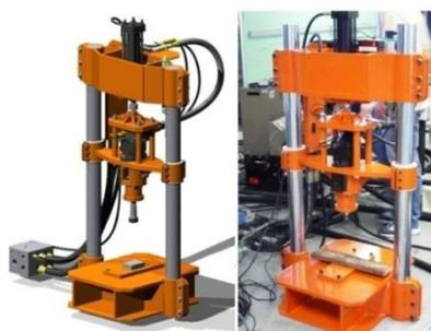
Figura 3. Máquina para processamento FHPP MSA 50.
