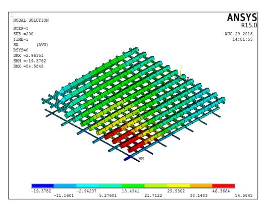
Figura 14 - Tensão normal das armaduras da laje L0-01
