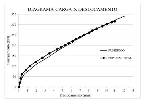
Figura 8 - Diagrama carga-deslocamento no centro da laje L1 de Coelho
