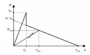
Figura 3 - Diagrama tensão-deformação para o concreto tracionado
