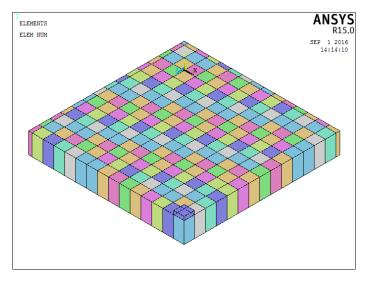
Figura 15 - Malha de elementos SOLID186
