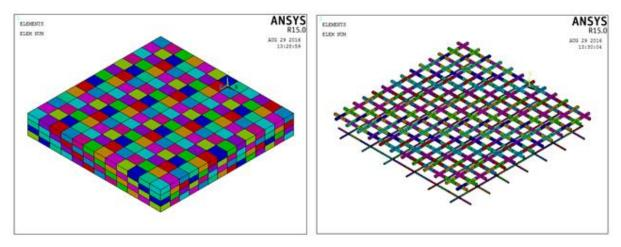
Figura 11 - Malha de elementos finitos e elementos de reforço
