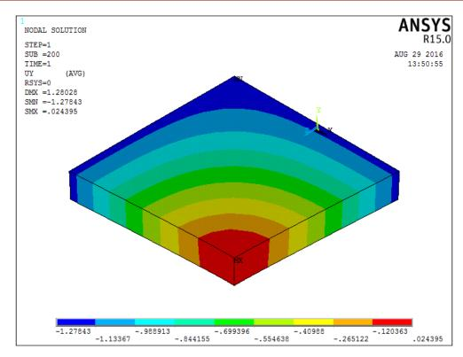
Figura 13 - Deslocamento vertical da laje
