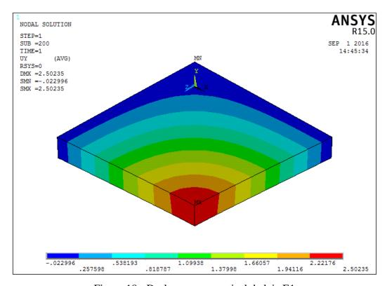
Figura 18 - Deslocamento vertical da laje E1
