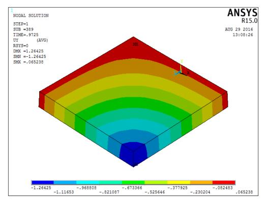
Figura 9 - Deslocamento vertical da laje
