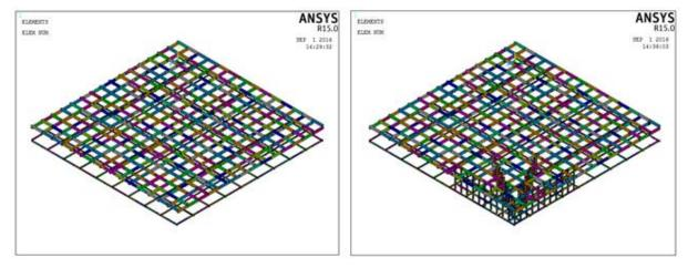
Figura 16 – Armadura de flexão e armadura de flexão juntamente com a armadura de cisalhamento
