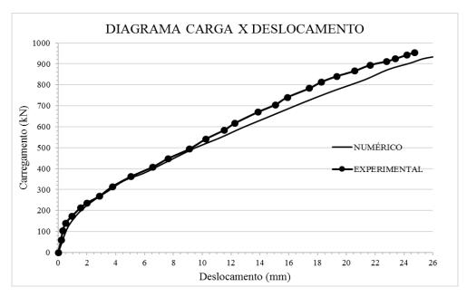
Figura 17 - Diagrama carga-deslocamento no centro da laje E1
