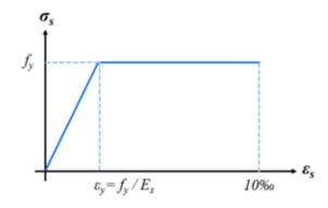
Figura 4 – Modelo elastoplástico perfeito para o aço
