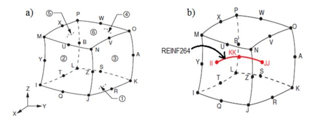
Figura 6 – a) Elemento SOLID186 b) Elemento REINF264
