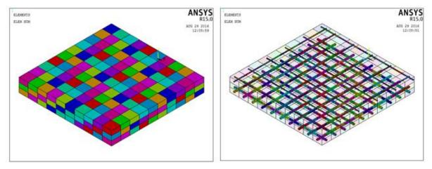
Figura 7 – Malha de elementos finitos e elementos de reforço
