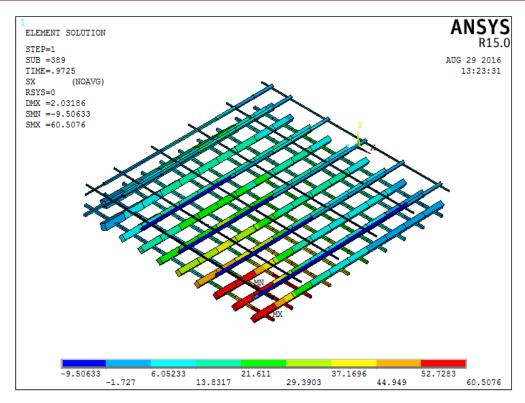
Figura 10 – Tensão normal nas armaduras de flexão
