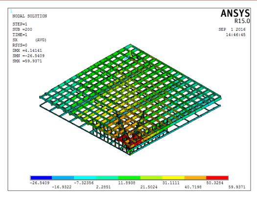
Figura 19 - tensão normal das armaduras da laje E1
