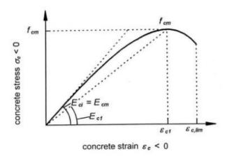
Figura 2 - Diagrama tensão-deformação para o concreto comprimido
