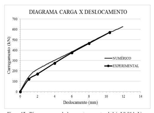
Figura 12 - Diagrama carga-deslocamento no centro da laje L0-01de Lima
