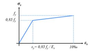
Figura 5 – Modelo elastoplástico com endurecimento linear
