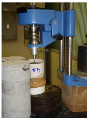
Figura 4 - Ensaio de palheta de laboratório na Subamostra #7c.
