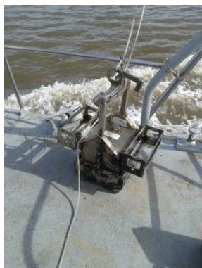
Figura 2 - Amostrador de fundo "box corer", tipo Ekman.
