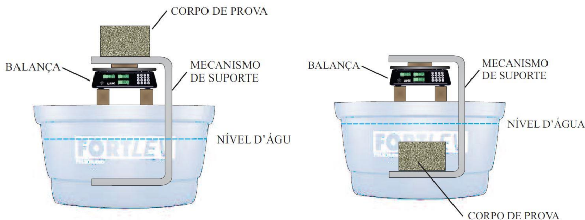
Figura 9. Esquema de determinação dos pesos seco e submerso para determinação do índice de vazios.
