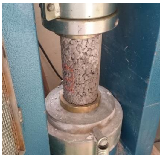
Figura 7. Rompimento de corpo de prova com auxílio de neoprene.
