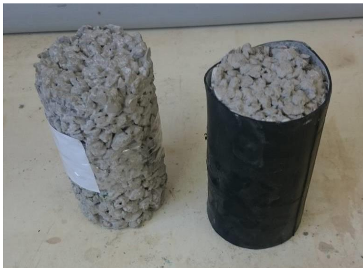
Figura 6. Revestimento dos corpos de prova para ensaio de permeabilidade
