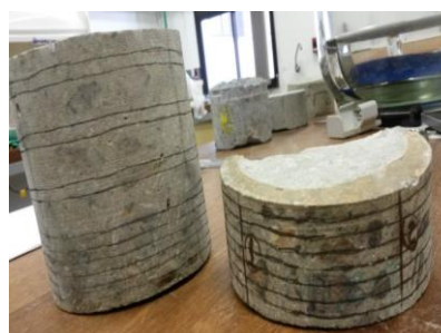
Figura 5. Testemunhos extraídos dos microambientes. Figura 6. Marcação para extração dos perfis de cloretos.
