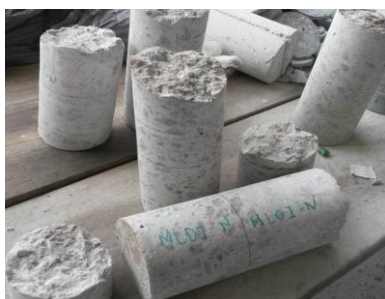
Figura 5. Testemunhos extraídos dos microambientes. Figura 6. Marcação para extração dos perfis de cloretos.
