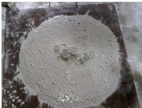
Figura 3- Ensaio de espalhamento para o concreto M80- 2,5.
