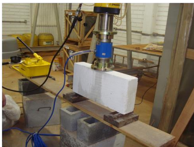
Figura 2: Célula de carga sobre o bloco Sical
