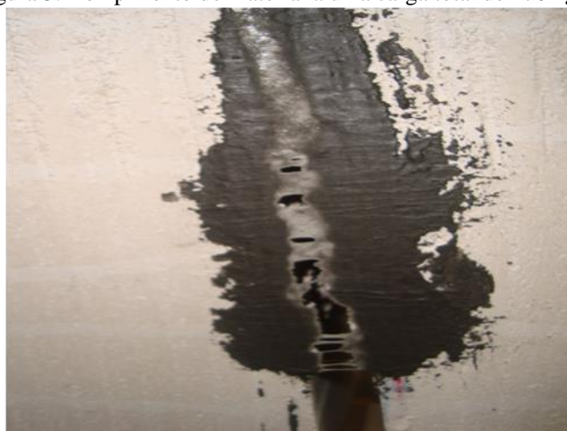
Figura 3: Rompimento do material a uma carga total de 170 kg
