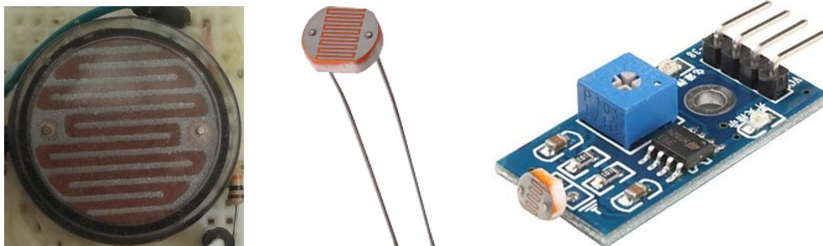
Figura 4 – Sensores LDR utilizados
