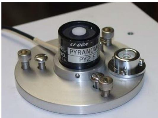
Figura 3 - Piranômetro fotoelétrico
