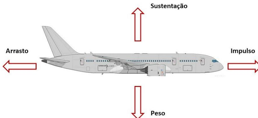
Figura 1 – Forças em uma aeronave durante voo nivelado
