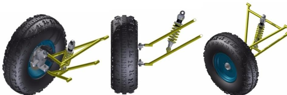
Figura 1 - Sistema de suspensão Duplo A.
