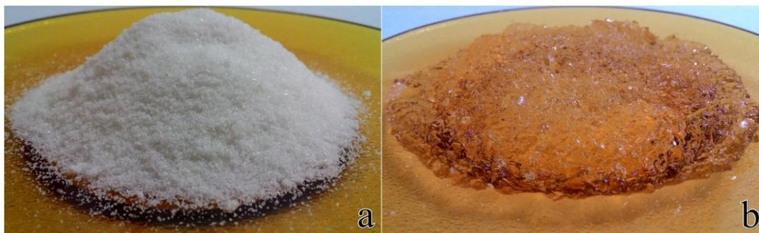
Figura 1 – Ensaio de consistência em mesa de espalhamento: (a) Amostra com 0% de polímero; (b) Amostra com 0,6% de polímero
