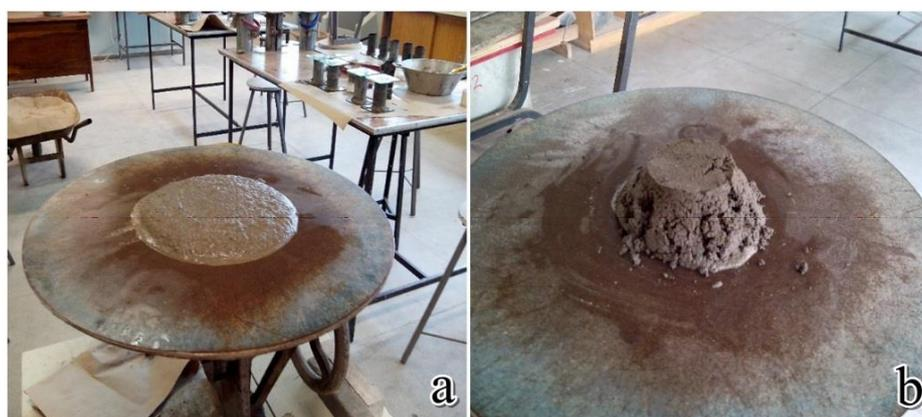
Figura 2 – Ensaio de consistência em mesa de espalhamento: (a) Amostra com 0% de polímero; (b) Amostra com 0,6% de polímero
