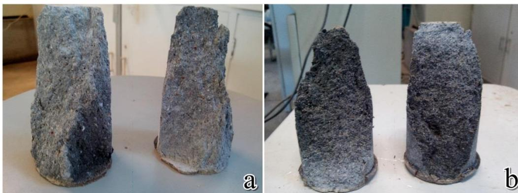
Figura 3 – Ensaio de compressão axial: (a) Amostra com 0% de polímero; (b) Amostra com 0,6% de polímero.
