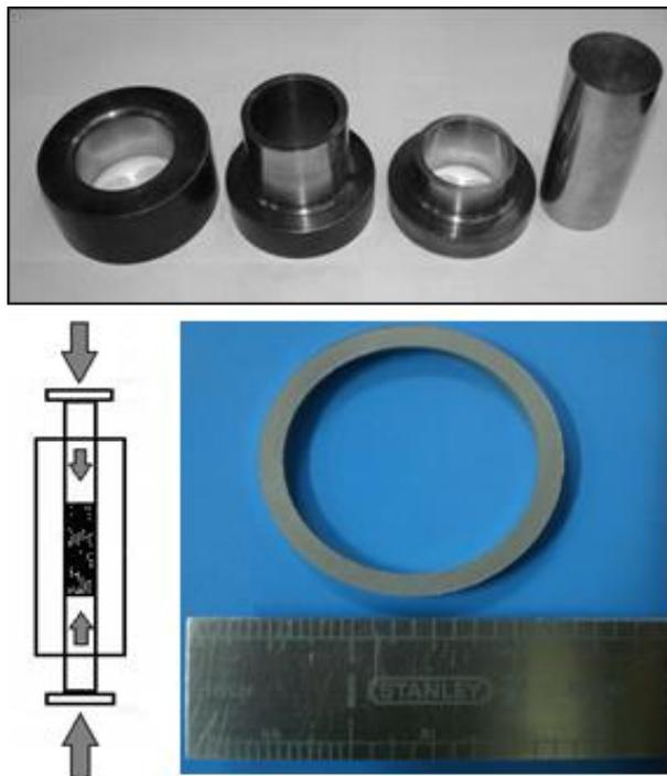
Figura 4 - Acima: componentes da matriz; Esquerda abaixo: compactação de duplo efeito; Direita Abaixo: amostra compactada.
