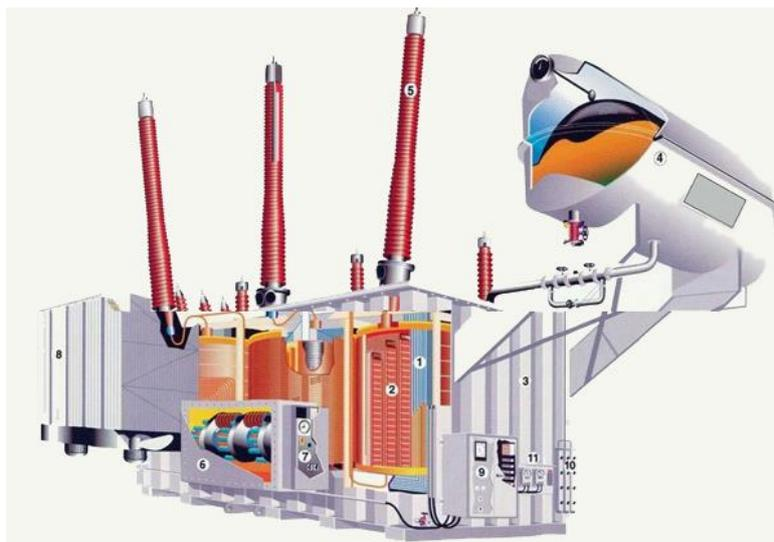
Figura 1 – Componentes de um Transformador de Potência
