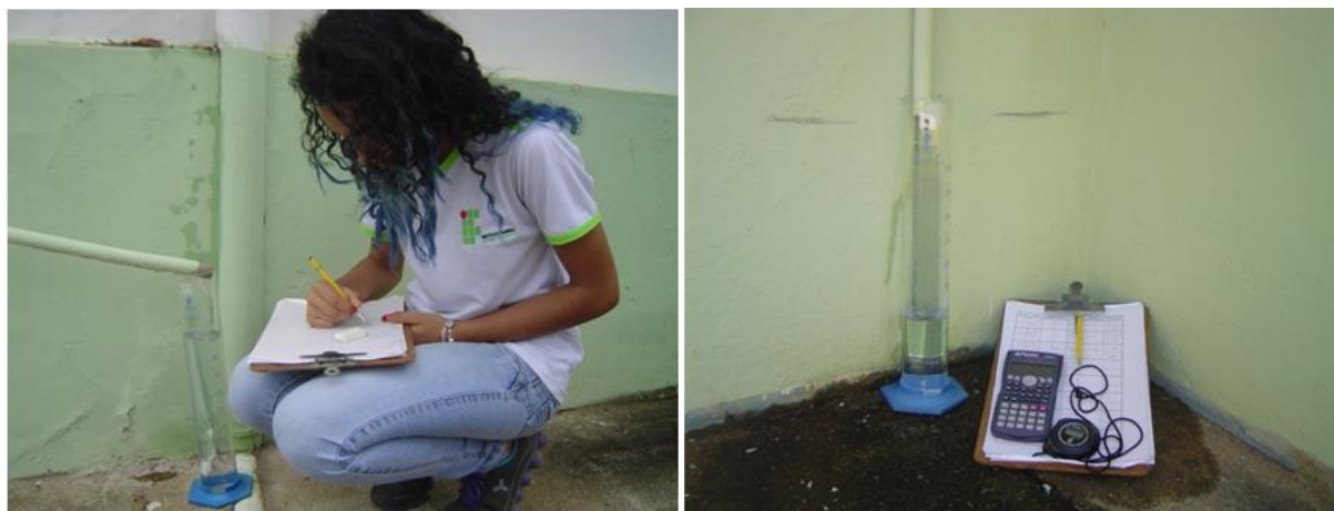
Figura 2 – Materiais utilizados para a mensuração da vazão dos aparelhos de Ar Condicionados. Foto: Elvis Pantaleão Ferreira (2015).
