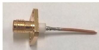
Figura 2b - Conector SMA Fêmea com prolongação da antena.
