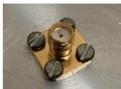
Figura 2a - Fixação do Conector na Tampa da Cavidade
