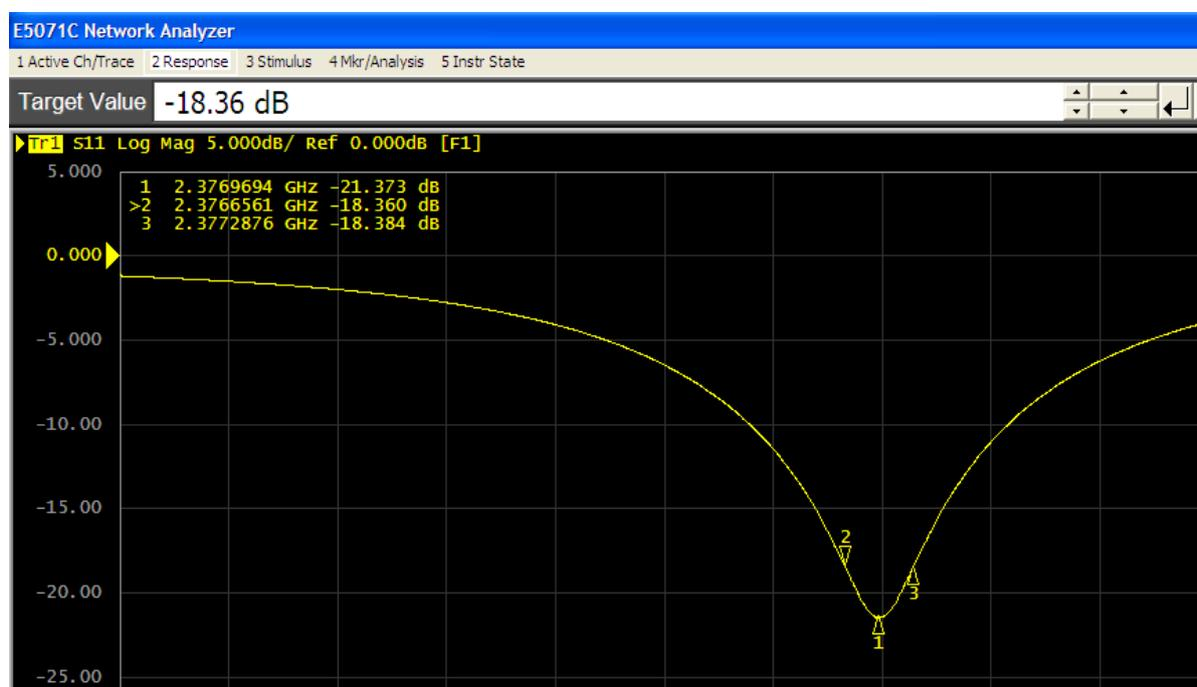
Figura 7 - Gráfico da Frequência da Ressonância cavidade em vazio ensaiada com o analisador de redes E5071.
