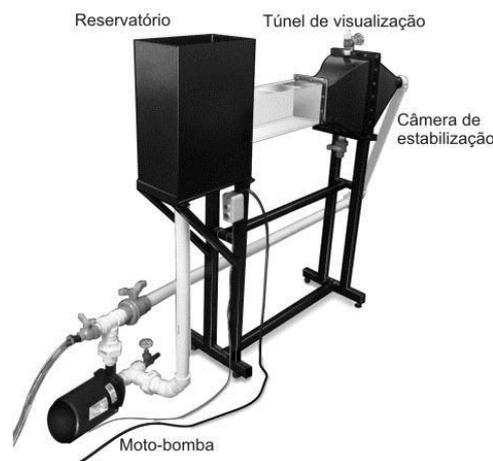
Figura 1 – Túnel Hidrocinemático
