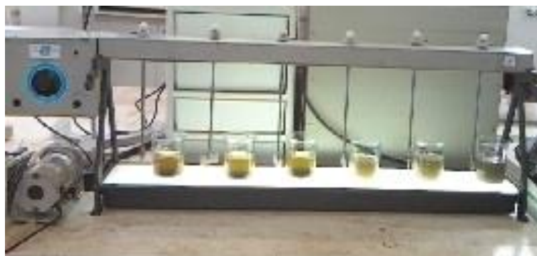
Figura 1. Imagem do Jar-Test utilizado nos experimentos
