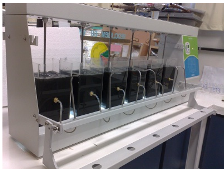
Figura 3 - Equipamento jartest com o lodo em processo de regeneração.
