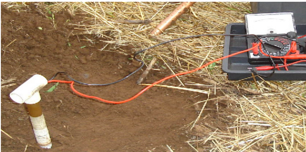
Figura 2 - Medição da resistência elétrica do solo com multímetro analógico
