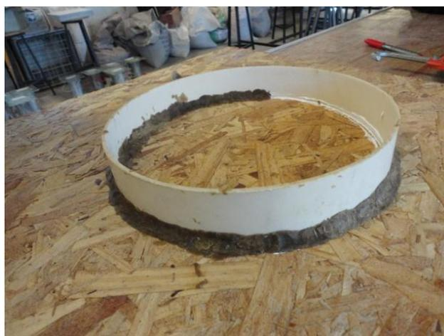
Figura 4 – Método de ensaio de lâmina d'água formado por uma tira de tubulação de PVC de 250 mm utilizando silicone para banheiros e cera de abelha na vedação da junta do sistema em contato com a placa OSB (Os autores, 2012)
