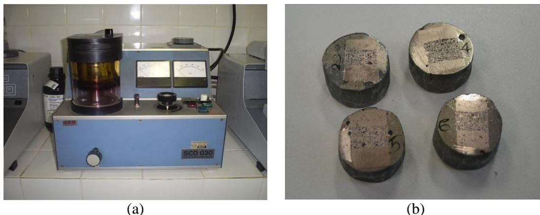
Figura 6 – Preparação das amostras para microscopia: (a) Equipamento utilizado para recobrimento das amostras com ouro; (b) Amostras após o recobrimento.
