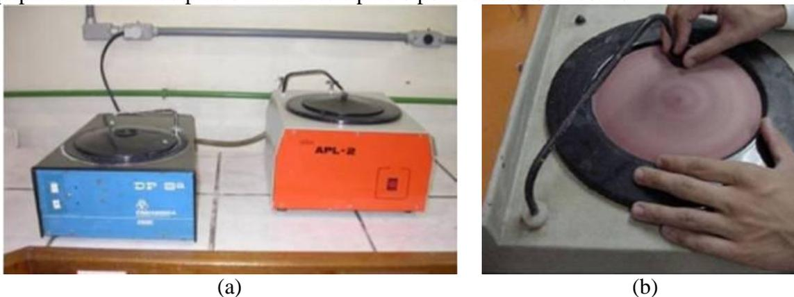
Figura 5 – Preparação das amostras para microscopia: (a) equipamentos para lixamento e polimento; (b) procedimento de lixamento.
