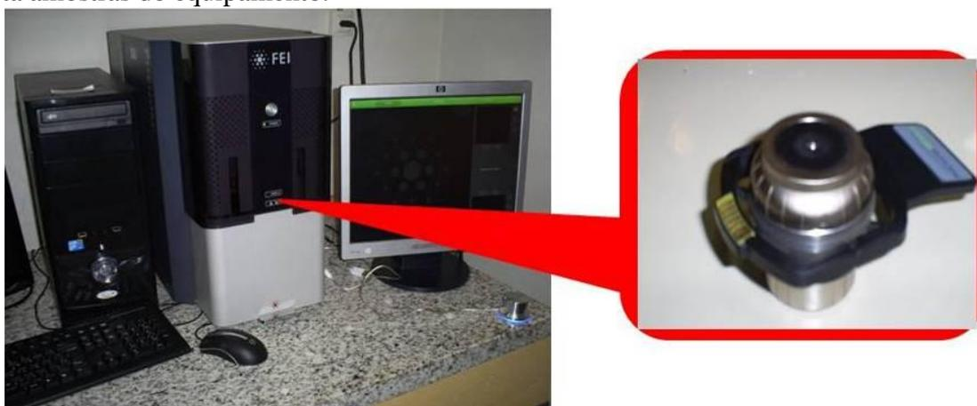
Figura 7 - Microscópio eletrônico de varredura – MEV de bancada com detalhe do porta amostras.
