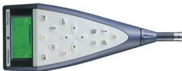
Figura 3 - Medidor de Nível de Pressão Sonora Brüel & Kjaer modelo 2238.
