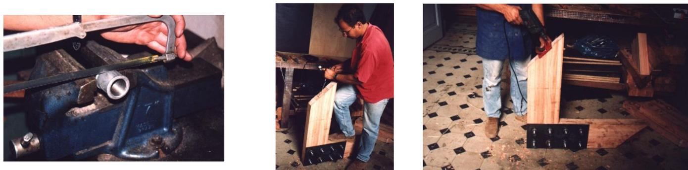
Figura 5 – Preparação da ligação e montagem do corpo-de-prova em forma de L
