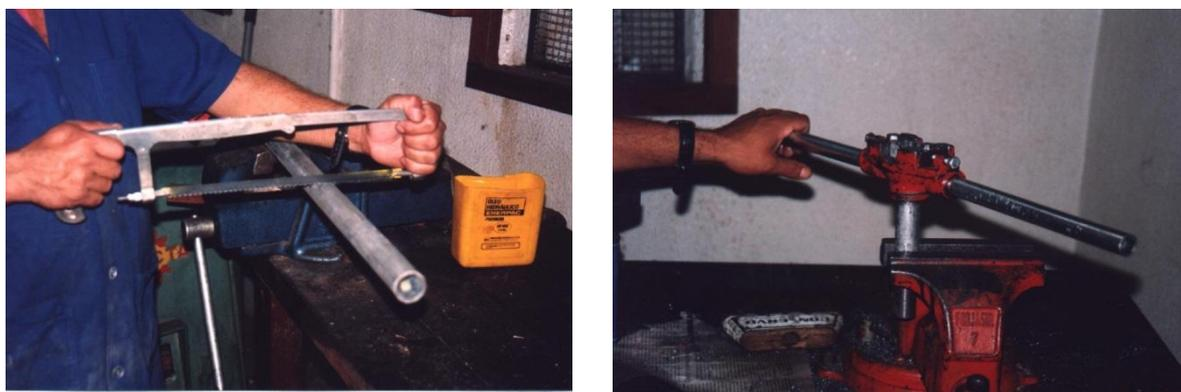
Figura 4 – Corte e roscas nas extremidades dos tubos
