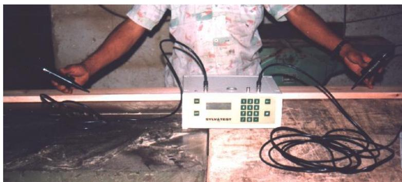
Figura 2 – Ensaio não destrutivo via ultrassom
