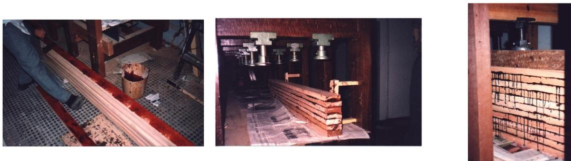
Figura 3 – Sequência da aplicação do adesivo nas lâminas e colocação do conjunto sob a prensa
