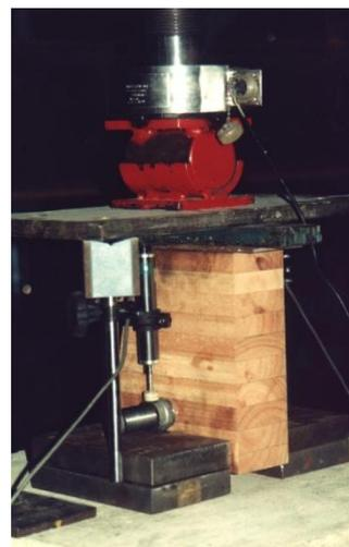
Figura 8 – Detalhes dos corpos de prova de embutimento (paralelo e normal às fibras)
