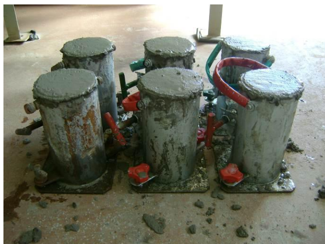
Figura 5– Preparação dos corpos de prova. FONTE: O Autor
