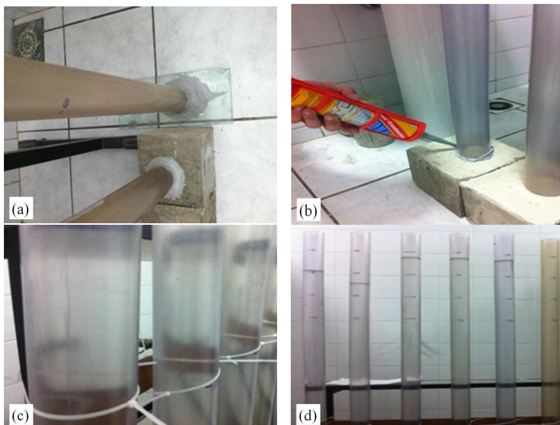
Figura 6: Ensaio de permeabilidade do concreto: (a) tubos fixados nos corpos de prova e na placa de vidro para medição de evaporação; (b) aplicação do silicone para vedar base do tubo; (c) lacres para fixação dos tubos e evitar movimentos; (d) estrutura do experimento de resistência à penetração de água.
