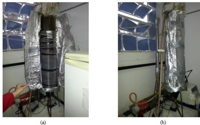
Figura 4 - Sistema para manutenção da temperatura interna do reator em 30 °C.
