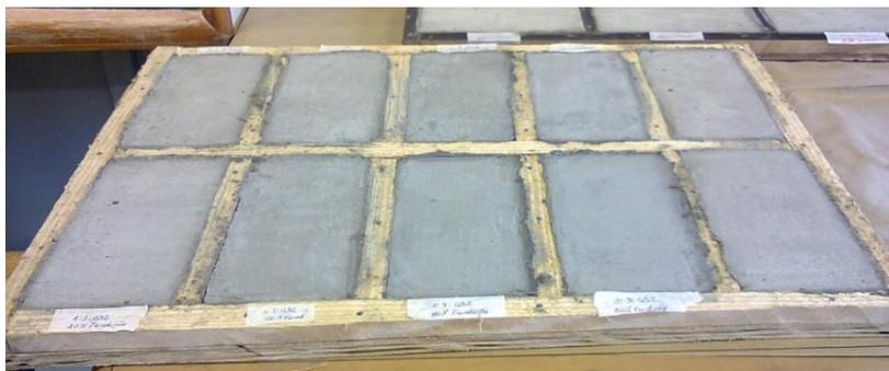
Figura 5 – Formas de argamassa para observar retração.
