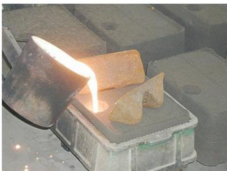
Figura 1 – Vazamento do metal fundido em molde de areia verde.
