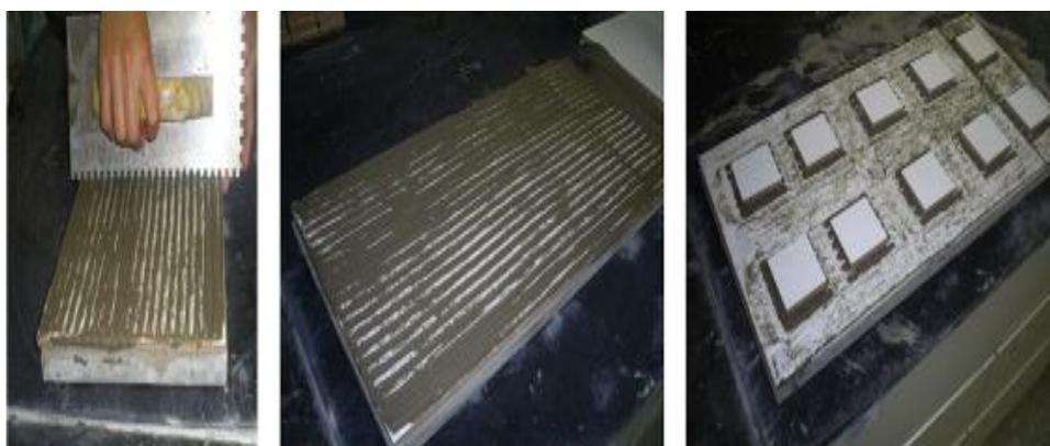
Figura 2 – Moldagem das placas cerâmicas para ensaio de resistência de aderência.
