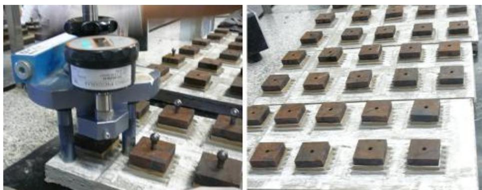
Figura 3 – Ensaios de resistência de aderência em laboratório: Equipamento e detalhes das dez pastilhas de metal já coladas sobre as placas cerâmicas para o ensaio.
