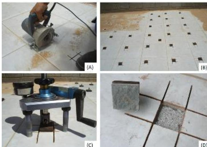
Figura 5 – Ensaios de resistência de aderência: (a) corte; (b) colagem das pastilhas; (b) Posicionamento do equipamento de arrancamento e; (d) detalhe do piso após o ensaio.
