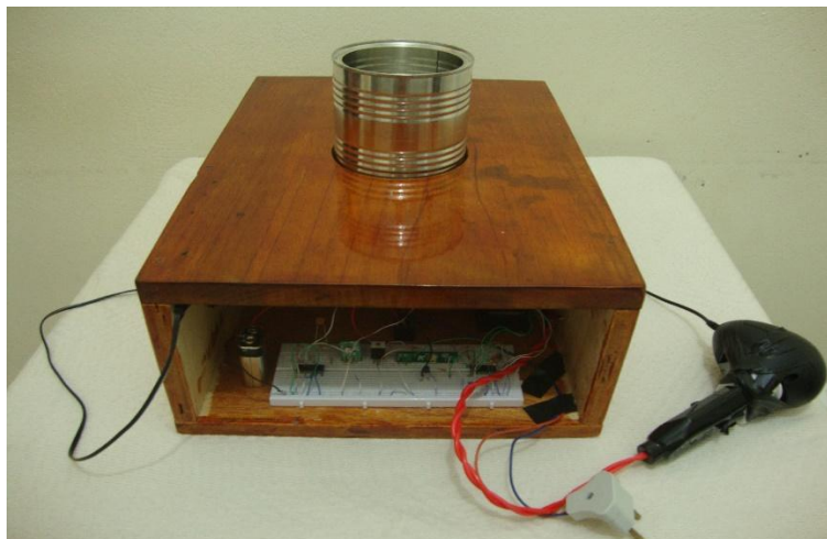
Figura 13: Protótipo de processo de aeração de grãos em silo vertical por controle remoto (Fonte: o autor).
