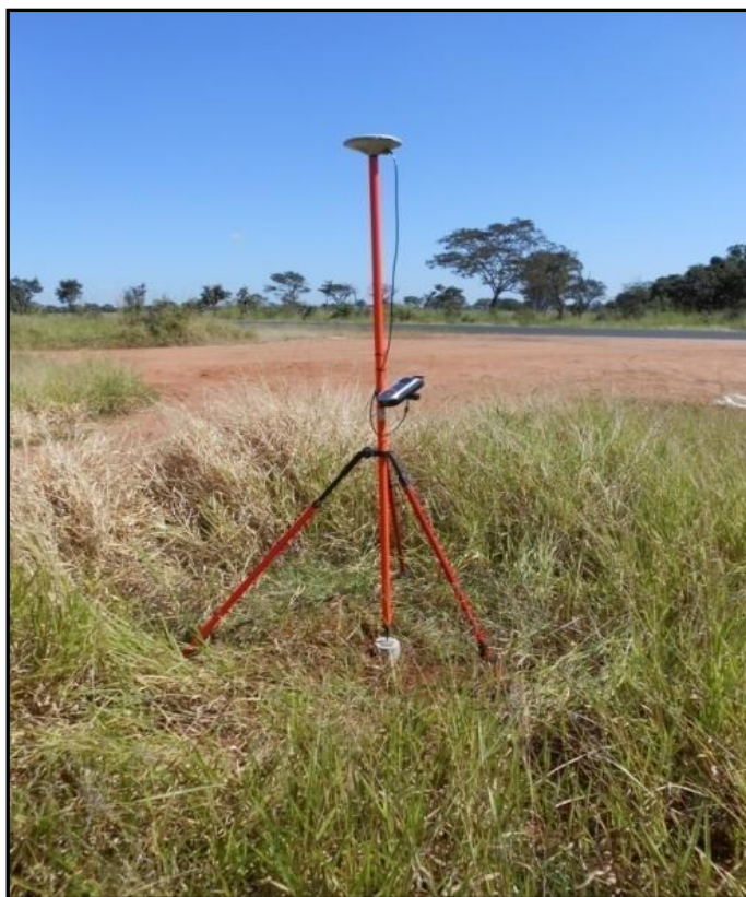
Figura 6 – Rastreio dos marcos com o GPS Promark100. Fonte: Autores (2013).
