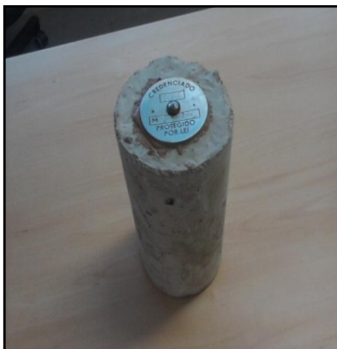
Figura 2 - Corpo de prova de concreto com chapa incrustada. Fonte: CHUERUBIM et. al. (2013).
