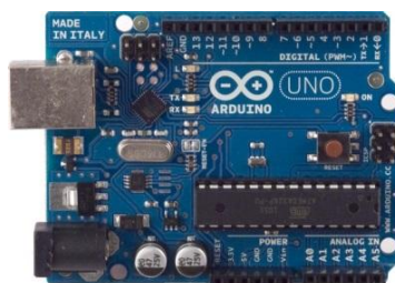
Figura 2 - Arduino UNO R3
