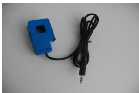
Figura 8 - Sensor de Corrente Elétrica SCT-013
