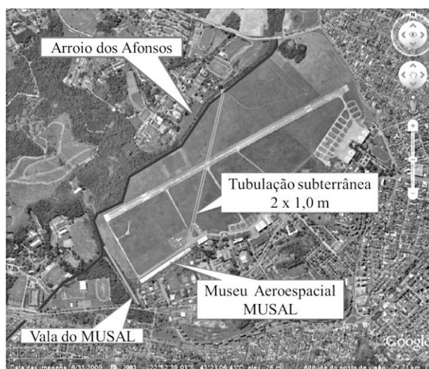
Figura 2. Área de estudo com indicação do Hangar do MUSAL, do Arroio dos Afonsos e da tubulação subterrânea de drenagem que atravessa a pista do aeródromo. Fonte: GoogleEarth adaptado.
