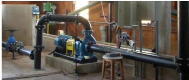
Figura 1– Conjunto moto bomba com decibêlfmetro e analisador de energia
