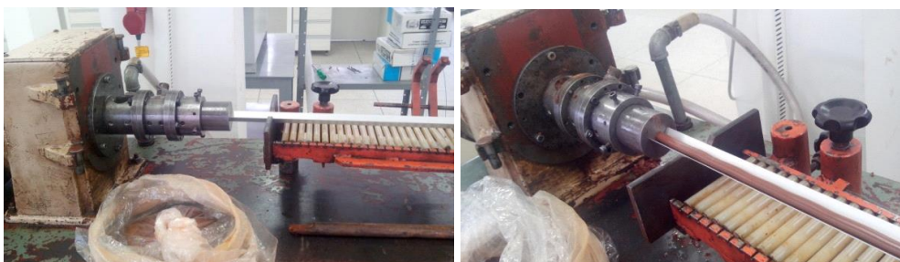
Figura 3. Conformação das membranas em uma extrusora à vácuo. (Fonte: Própria)
