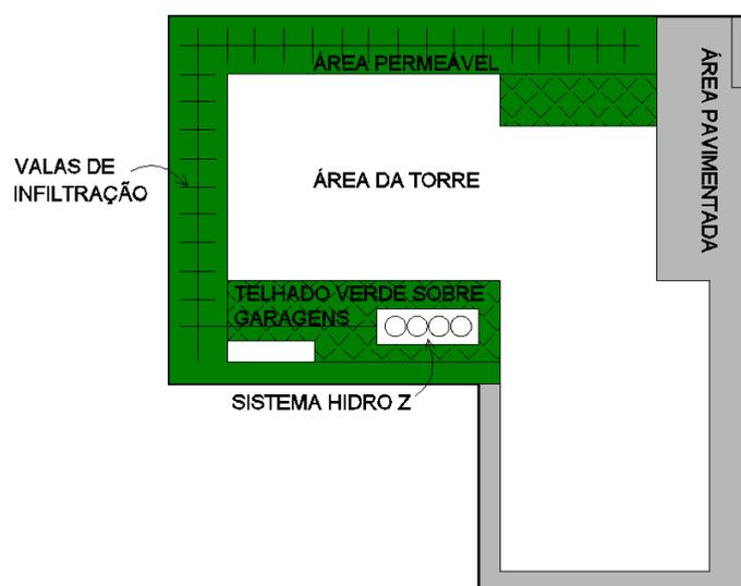
Figura 2 – Esquema das valas de infiltração do efluente do sistema Hidro Z®
