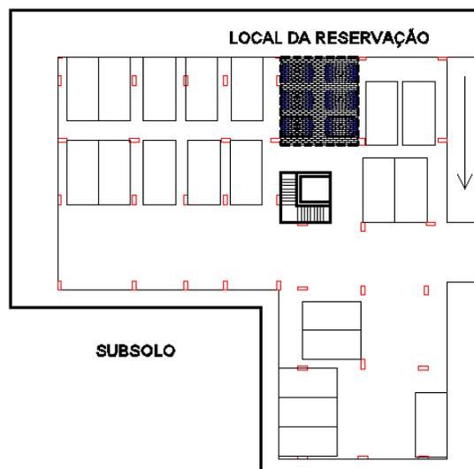
Figura 18 – Posicionamento das cisternas no subsolo
