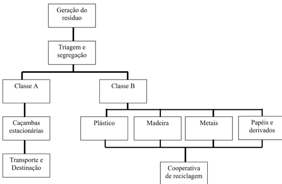
Figura 2- Fluxograma do gerenciamento dos resíduos de construção da obra em estudo.
