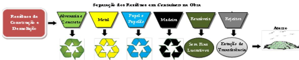
Figura 3 – Opção de gestão de RCD com separação de todo o resíduo na obra
