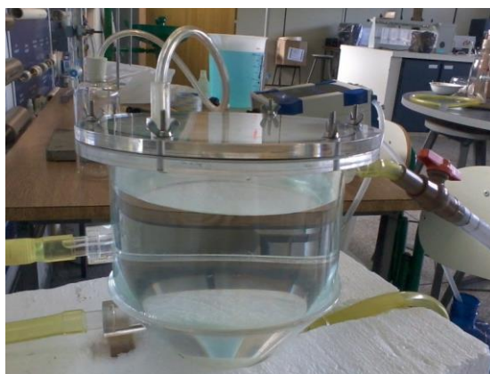
Figura 2 – Fotografia do RALF de bancada utilizado nos ensaios hidrodinâmicos Fonte: Comin et al. (2013)
