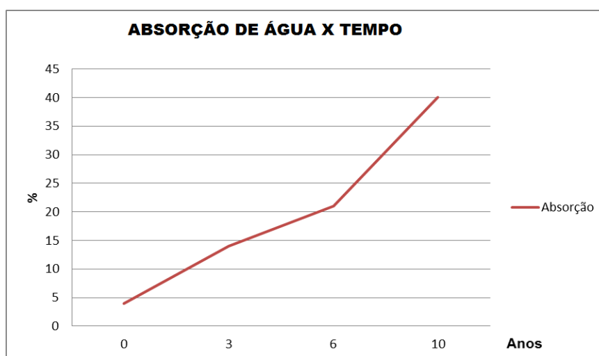
Figura 3 – Absorção de água telha ecológica em diferentes idades
