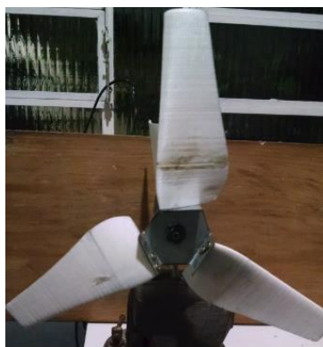
Figura 5 – Pás montadas com cubo de metal.
