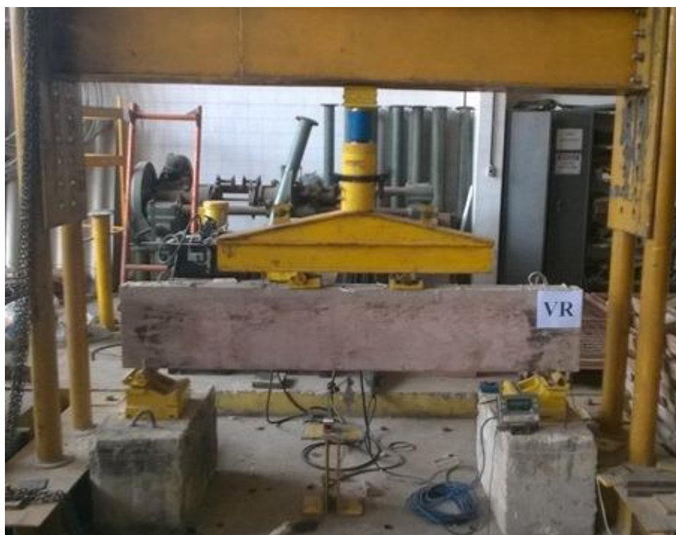
Figura 9 – Viga VR esquema do modelo de ensaio de Stuttgart
