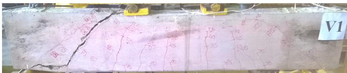
Figura 10 – Viga VR pós-ensaio / Mapa de Fissuração
