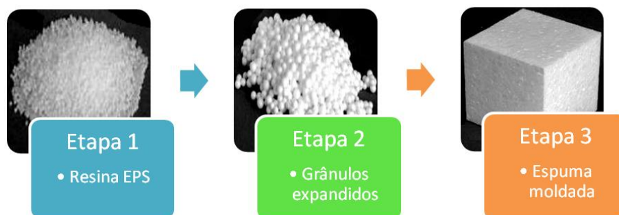
Figura 2 - Estágios de construção (NH, 2014).
