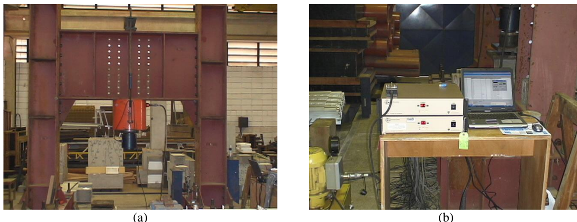
Figura 5 – Pórtico metálico e sistema de aquisição utilizados nos ensaios experimentais
