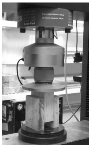
Figura 5: Ensaio de cisalhamento do corpo de prova com corte duplo na EMIC. Fonte: Araújo (2015).
