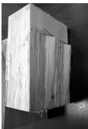
Ruptura mista (Madeira/resina)
