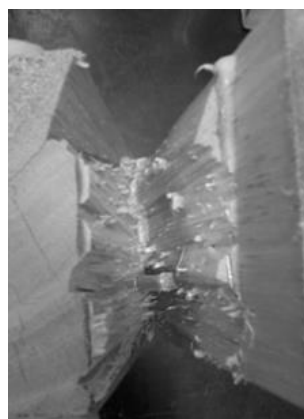
Ruptura na madeira
