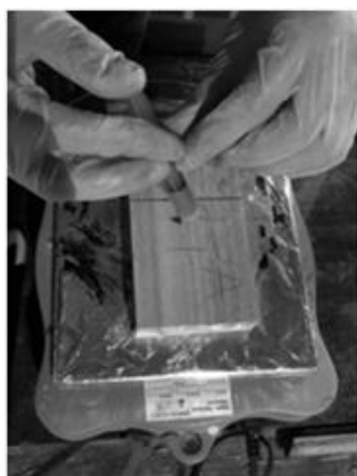
Aplicação da resina com seringa
