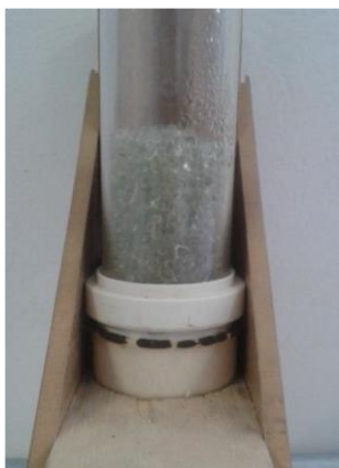
Figura 1 - leito composto por esferas de vidro de 3 mm
