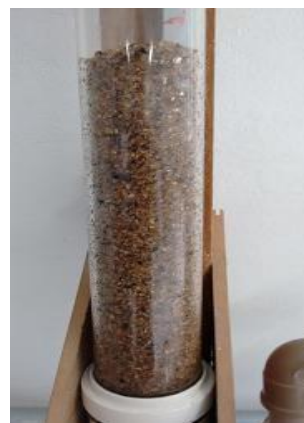
Figura 2 - leito composto por areia de granulometria entre 1 e 2 mm.
